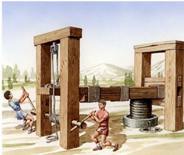
Sistema de palanca y torno
